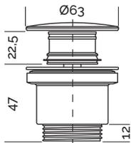
Bonde à écoulement livre Akron (mm)
