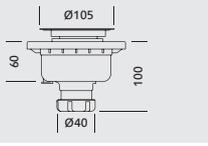
Bonde de sortie verticale |                                                                                     | <input checked="" type="checkbox"/> |
