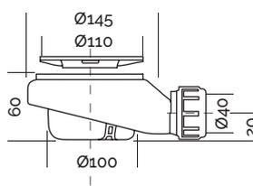
Ablauf für großen Durchfluss mit waagrechtem Ausgang (mm)
