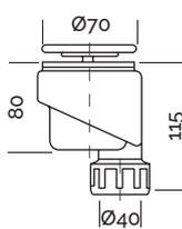
Extraflacher Ablauf mit waagrechtem Ausgang (mm)
