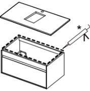
• La encimera debe apoyar en los 4 LADOS. En encimeras de 100cm con lavabo desplazado añadiremos un APOYO ADICIONAL LATERAL. En las encimeras de 100/120 cm con 2 lavabos añadiremos un APOYO ADICIONAL EN EL CENTRO.
