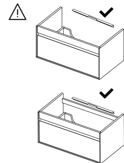
• La encimera debe apoyar en los 4 LADOS. En encimeras de 100cm con lavabo desplazado añadiremos un APOYO ADICIONAL LATERAL. En las encimeras de 100/120 cm con 2 lavabos añadiremos un APOYO ADICIONAL EN EL CENTRO.
